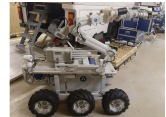
UGV VNIIA : robot 6 roues sur châssis modulaire
