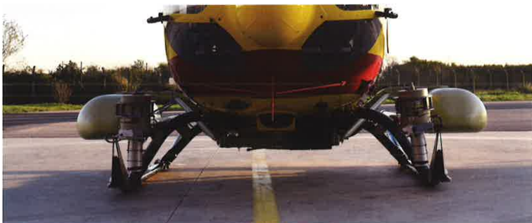
Montage symétrique des détecteurs sur le berceau porteur fixé sous l'hélicoptère
