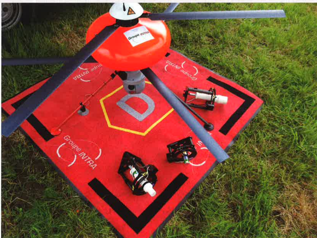
Drone électrique avec batterie, caméra boule et sondes de mesures radiologiques.
