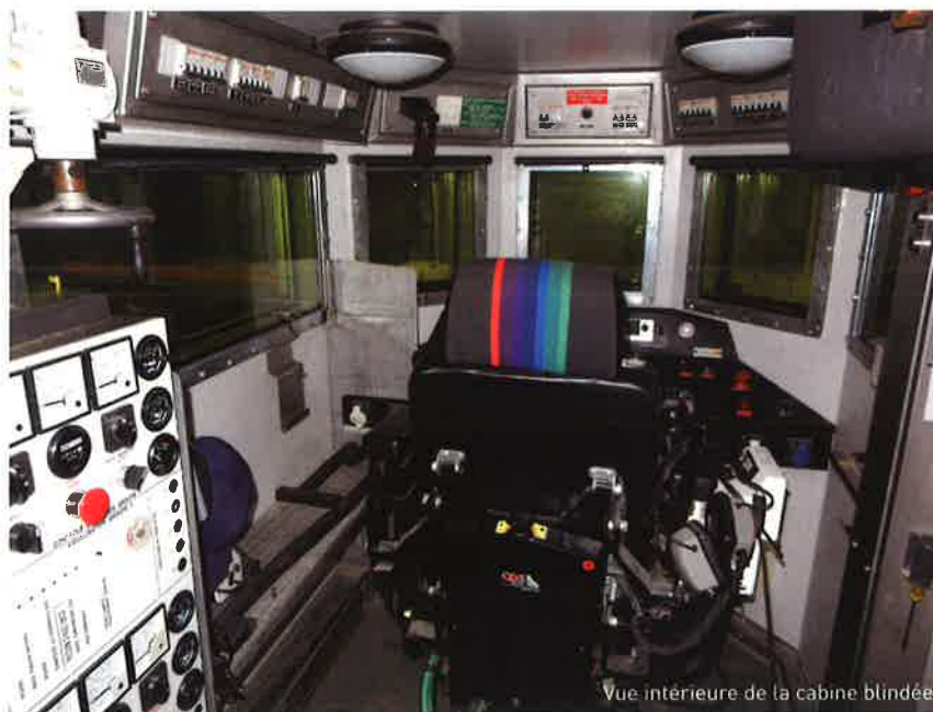
Cabine blindée avec servitudes : ventilation nucléaire et groupe électrogène
