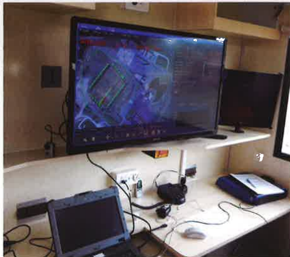
Intérieur poste de pilotage drone avec écran de visualisation et station sol.
