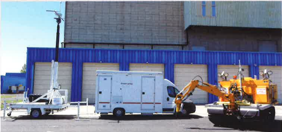
Ensemble remorque-mât porte antennes, poste de pilotage et engin d'extérieur
