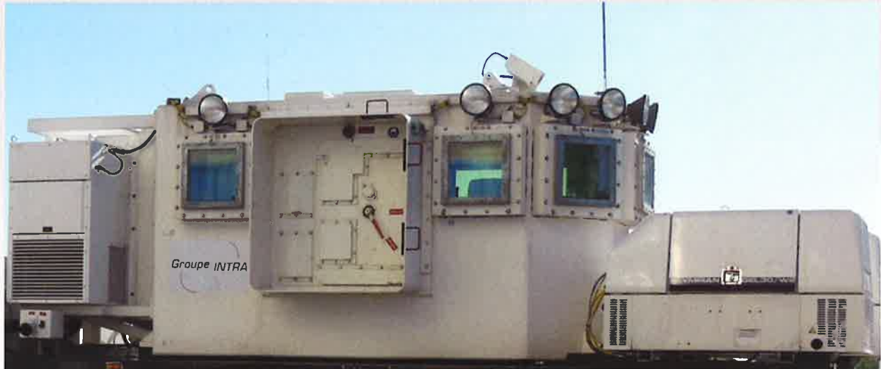
Cabine blindée avec servitudes : ventilation nucléaire et groupe électrogène
